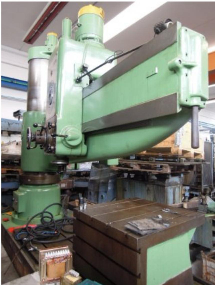
**Trapano radiale con capacità di foratura 110mm; 24 velocità 19 – 1540 giri/min; sbraccio max. 3020mm; raggio min - max di foratura 695-3345mm; altezza min - max naso mandrino sulla piastra base 540-2250mm; Sede conica del mandrino cono Morse 6; completo di cubo**
